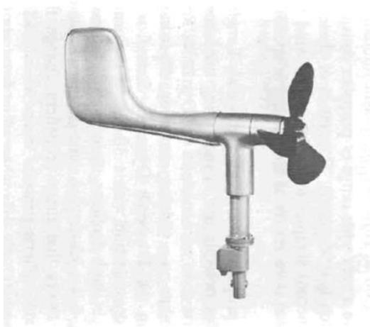
Figura 3.20 – O anemômetro de hélice Bendix-Friez (Gill, 1973).
