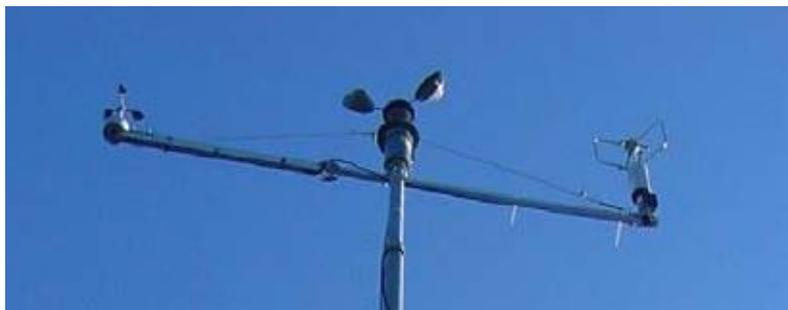
Figura 3.26 – Anemômetro concha Vaisala WAA151 (esquerda), anemômetro concha Synchronac 706 (meio), e anemômetro ultrassônico RM Young Model 8100 3D (Gorman, 2004).
